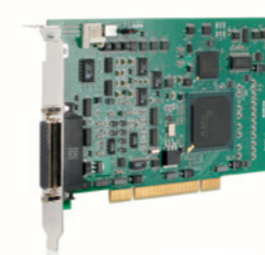
Framegrabber-Karte für Epson Vision Guide 6.0 Advanced
