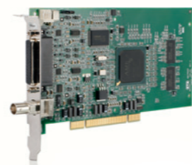
Framegrabber-Karte für Epson Vision Guide 6.0 Standard
