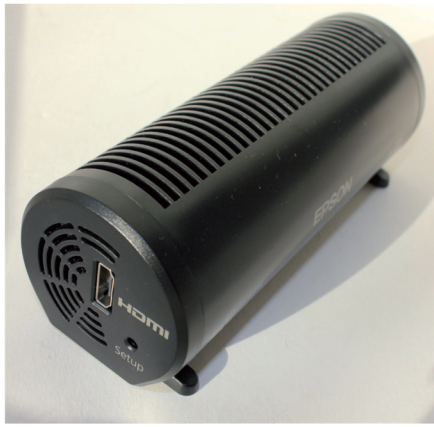
K modelu TW-6000W (a k ostatním, označeným písmenem "W" je přiložen bezdrátový vysílač signálu HDMI. Ten si bez problému poradí i s 3D obrazem. Bezdrátové spojení výrazně usnadňuje instalaci do prostor, které nejsou vybaveny HDMI kabelem, nebo instalovaný kabel již nevládá objem dat nutný pro 3D zobrazení.
