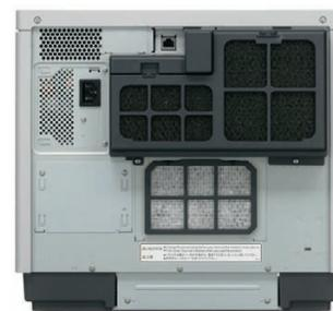
Les ventilateurs projettent de l'air dans la machine pour éviter qu'elle ne surchauffe. La surpression est constante pour que la machine reste hermétique à la poussière.
