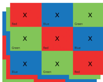
Bei der Farbhelligkeit werden drei Sätze eines Neun-Punkt-Rasters zur Messung der Grundfarben Rot, Grün und Blau verwendet.
