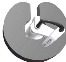
SCARA-Roboter: Nierenförmiger Arbeitsbereich mit Totzone
